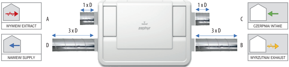
Rys. 12. Minimalne długości przewodów powietrznych
